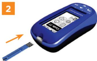
L'écran affiche brièvement le mode actuellement configuré. Un symbole de goutte clignotante s'affiche ensuite pour indiquer que l'appareil de mesure est prêt à prendre une mesure. La température ambiante de l'appareil de mesure s'affiche en dessous de la ligne d'informations **3**.
