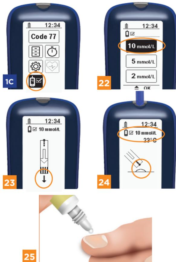
Pressez une autre gouttelette. Déplacez ensuite l'appareil de mesure avec le capteur inséré vers la gouttelette. Laissez la gouttelette remplir la chambre de mesure jusqu'à ce que l'ouverture de l'échantillon de sang soit immergée dans la gouttelette. Un signal sonore retentit lorsque le remplissage s'est effectué correctement et le test commence.
